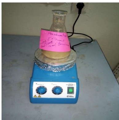
Photo14 : Agitation magnétique pendant la macération
