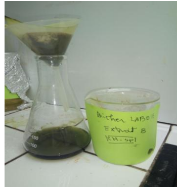
Photo 06 : Filtration de l'extrait ( Cichorium intybus )
